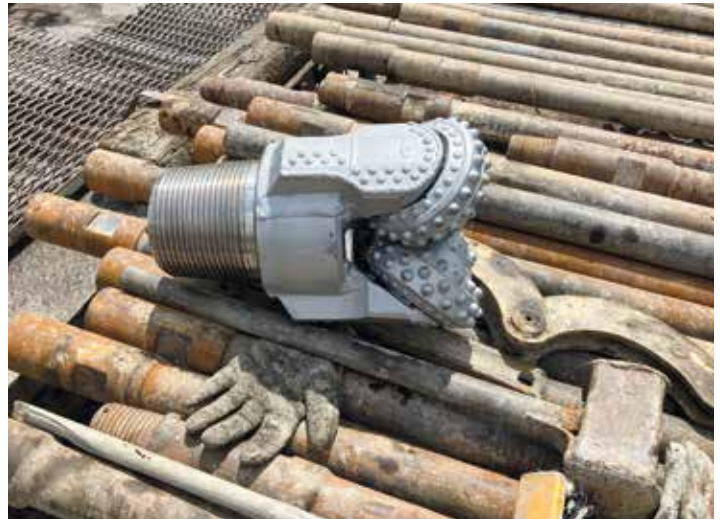
■ Der Bauunternehmer Veaceslav Scutaru erklärt uns die Funktionsweise des sehr teuren Bohrkopfes, welcher max. nach zwei Bohrprojekten ausgetauscht werden muss.
