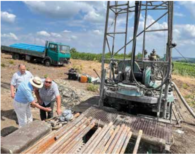
■ Der Bauunternehmer Veaceslav Scutaru erklärt uns die Funktionsweise des sehr teuren Bohrkopfes, welcher max. nach zwei Bohrprojekten ausgetauscht werden muss.
