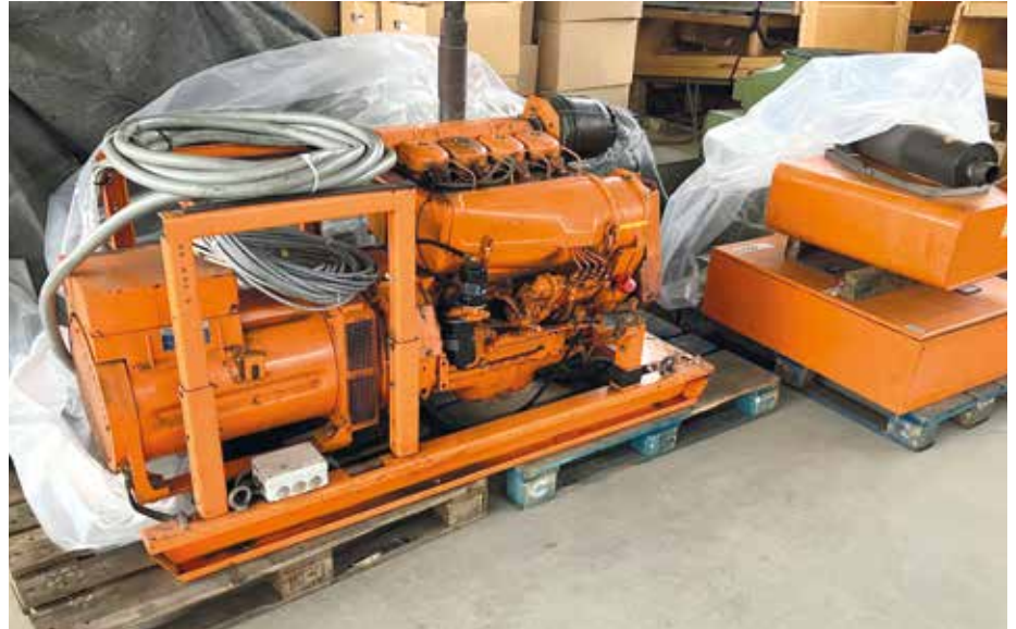
■ Der 36-KW Dieselgenerator mit Schaltschrank und Tank steht für eine weitere Sozialeinrichtung zum Abtransport bereit. Bild: Pro Humanitate
